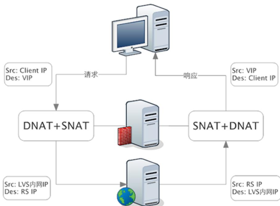
1. 在包从 LVS 转到 RS 的过程中，源地址从客户端 IP 被替换成了 LVS 的内网 IP。内网 IP 之间可以通过多个交换机跨 VLAN 通信。目标地址从 VIP 修改为 RS IP。
