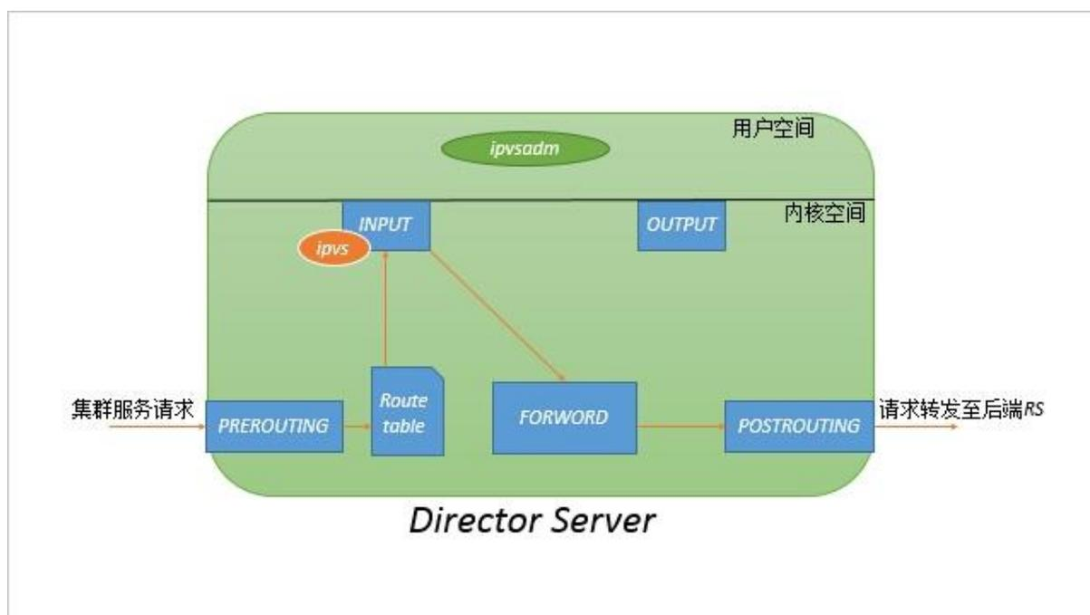
`ipvs` 工作于内核空间的 `INPUT` 链上，当收到用户请求某集群服务时，经过 `PREROUTING` 链，经检查本机路由表，送往 `INPUT` 链；在进入 `netfilter` 的 `INPUT` 链时，`ipvs` 强行将请求报文通过 `ipvsadm` 定义的集群服务策略的路径改为 `FORWORD` 链，将报文转发至后端真实提供服务的主机。
