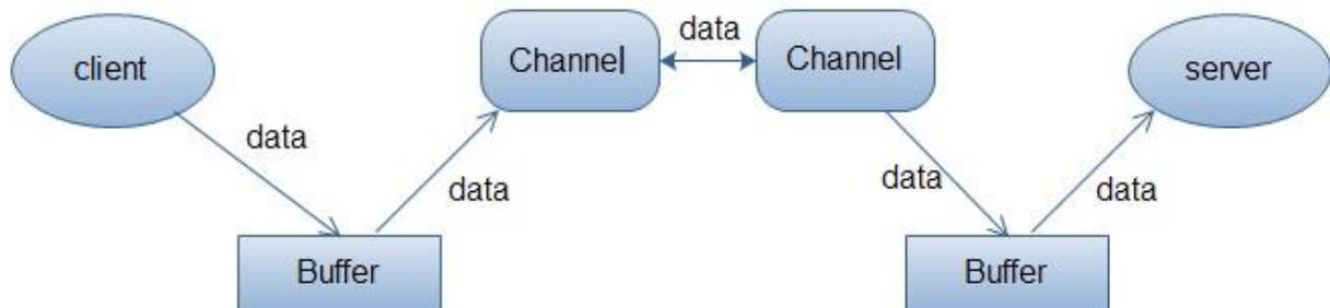
上面的图描述了从一个客户端向服务端发送数据，然后服务端接收数据的过程。客户端发送数据时，必须先将数据存入 Buffer 中，然后将 Buffer 中的内容写入通道。服务端这边接收数据必须通过 Channel 将数据读入到 Buffer 中，然后再从 Buffer 中取出数据来处理。
